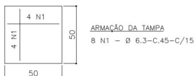
DETALHE DA TAMPA
